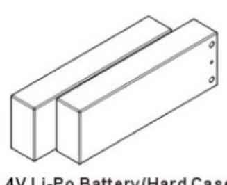
7.4V Li-Po Battery (Hard Case) 7.4 / 鋰充電電池組(硬殼)
