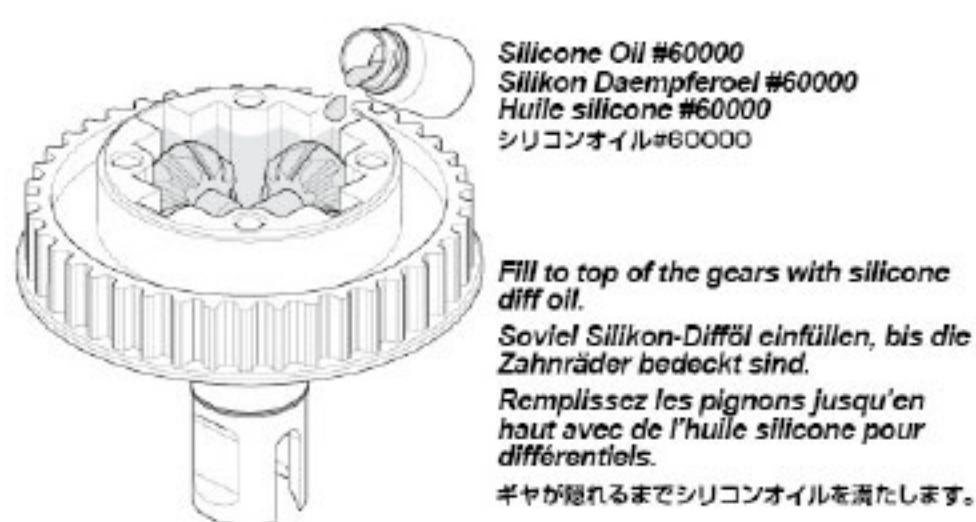
*Fill to top of the gears with silicone diff oil.**Soviel Silikon-Difföl einfüllen, bis die Zahnräder bedeckt sind.**Remplissez les pignons jusqu'en haut avec de l'huile silicone pour différentiels.**ギヤが隠れるまでシリコンオイルを添えます。*
